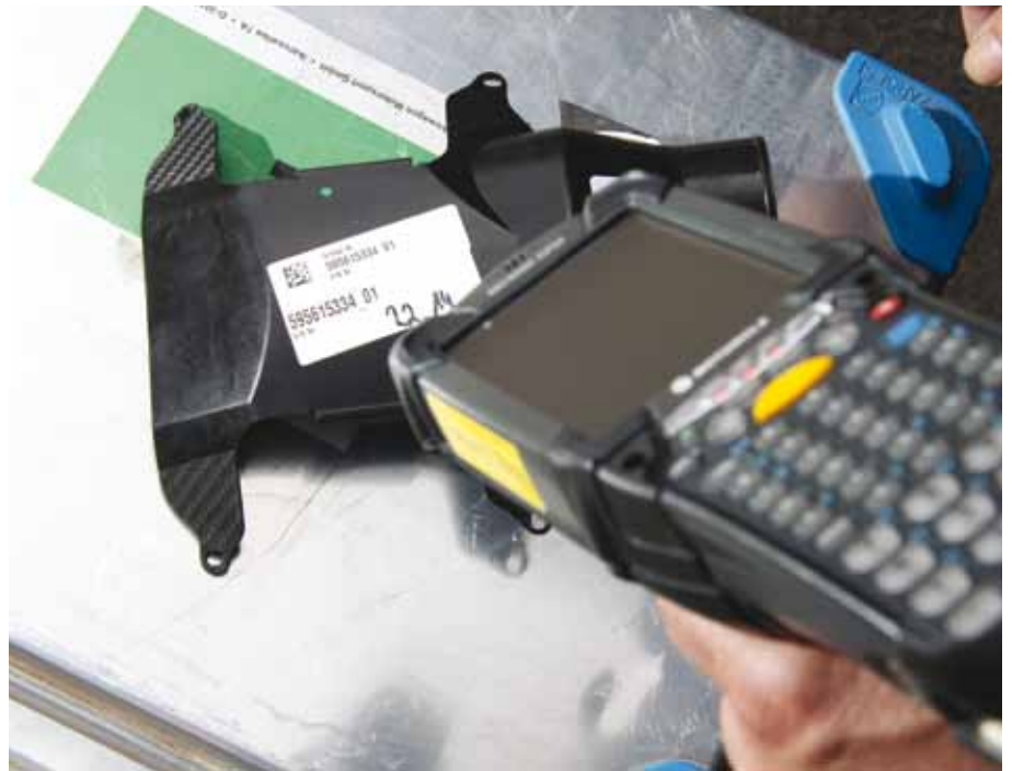
Mit Hilfe der Barcode-Scanner wird jeder Austausch eines Teils erfasst. Quelle: VW Motorsport
