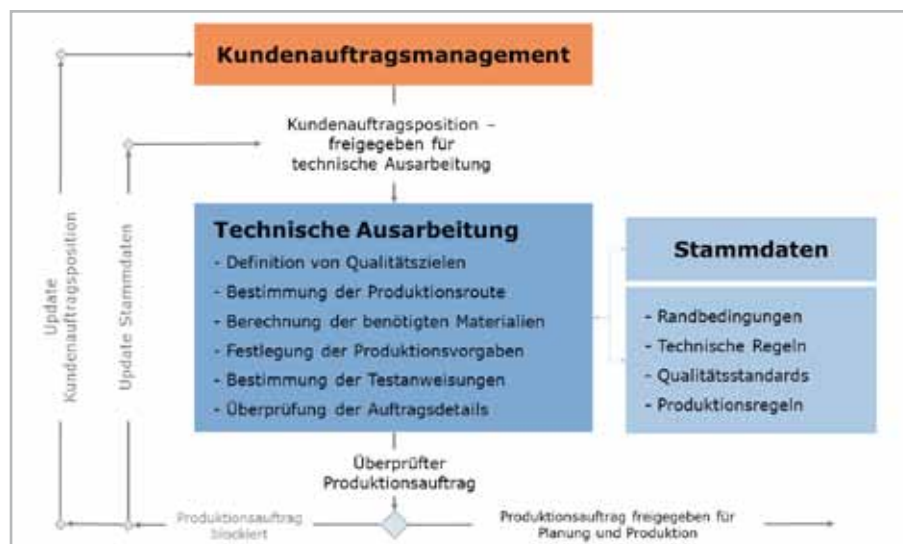
Workflow der technischen Auftragspezifikation mit PSImetals Order Dressing Quelle: PSI Metals
