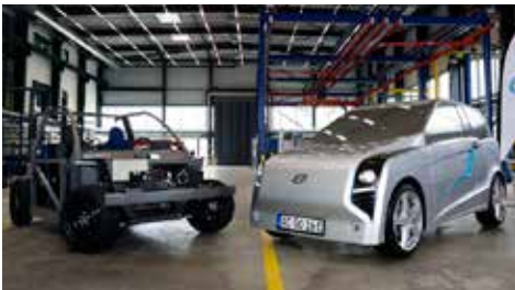
Verprobung von Außen-Design und Bosch-Antriebsstrang im Rolling Chassis des Elektroautos e.GO Life.
